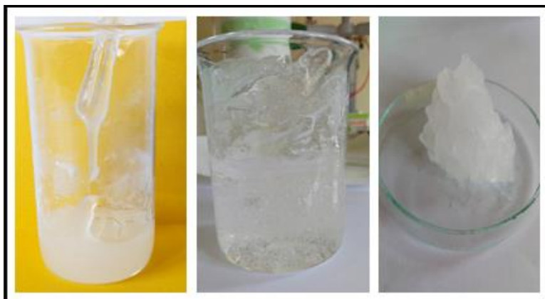
RYS.II.3.2.1. Żel powstały po dodaniu 7% mas. \text{SiO}_2 do oleju mineralnego przed dodaniem cząstek magnetycznych.
