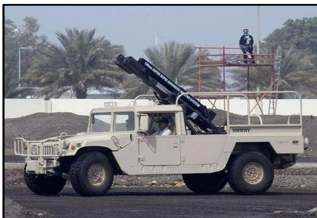
RYS.II.4.4.5.1. Wojskowy pojazd kołowy, służący do ostrzału moździerzowego, wykorzystujący amortyzatory MR jako podstawowe zawieszenie do sterowania ruchami podwozia [111].
