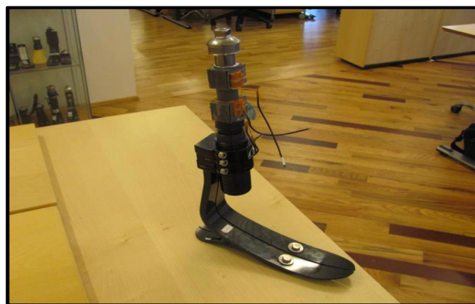
RYS.II.5.3.3. Prototyp stopy protetycznej z elementem sprężynowym MRE [63].
