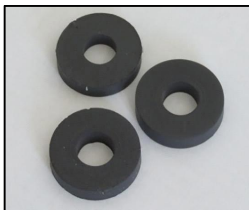
RYS.II.5.1.4. Elastomery MR w kształcie pierścienia [35].
