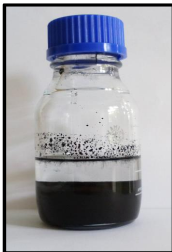
RYS.II.3.1.2. Proces sedymentacji występujący w cieczy magnetoreologicznej.
