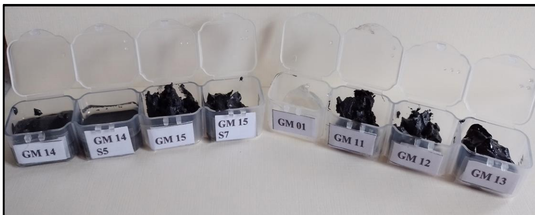
RYS.II.4.2.3.3. Widok próbek żeli zawierających w swoim składzie olej silikonowy, cząstki magnetyczne, różne dodatki oraz SiO 2 o zawartościach mas. od 7% do 10%.
