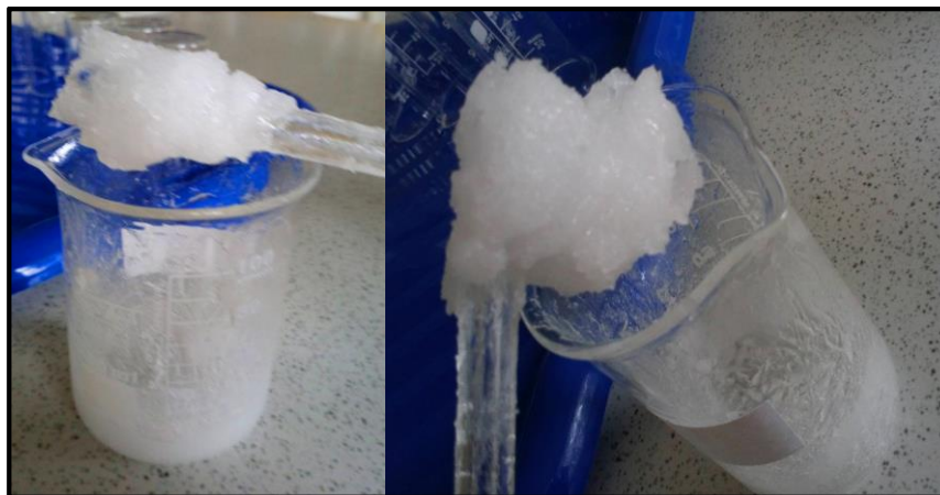
RYS.II.4.2.3.2. Próbkę żelu zawierająca olej silikonowy i SiO 2 bez cząstek magnetycznych.
