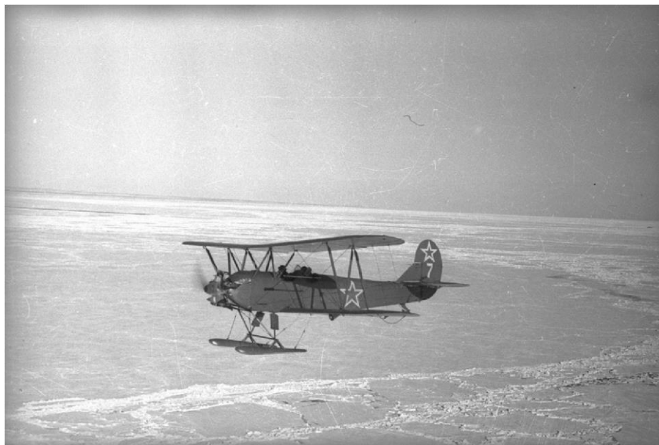
Fot. 107 Samolot Po-2 z zamontowanymi nartami. Źródło: russiaphoto.ru, domena publiczna
